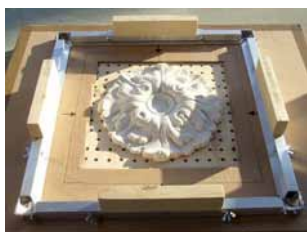
Boîte à vide, cache en carton, cadre de thermoformage et master.
