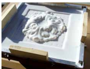
Thermoformage sous vide d'un moule pour élément de déco en pierre reconstituée.
