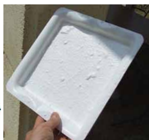
Moule plastique par thermoformage direct
