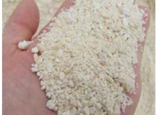
Le matériau idéal est relativement tendre et de granulométrie 0/4 ou 0/6. Il est composé de grains de calcaire fin qui vont de la poussière à des morceaux de 4 ou 6mm de diamètre. Sa couleur est blanc crème avec éventuellement des grains de couleur ocre-jaune. Il a la propriété d'être "**compactable**".
