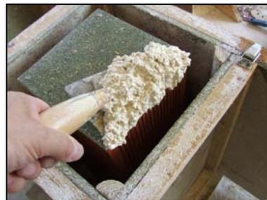
Remplissage à la truelle. Maintenir la brique en place d'une main et remplir avec l'autre main.
