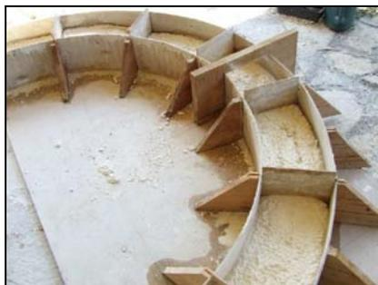
Le mortier calcaire prend relativement vite. Il ne faut pas tarder entre les deux tournées de 60 litres pour éviter les défauts d'homogénéité des pierres.
